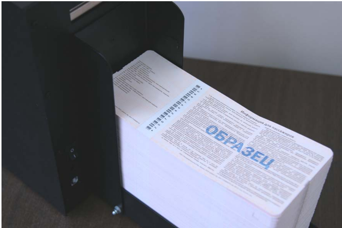
Рисунок 1.16а – Установка пачки БСО в лоток БПУ
