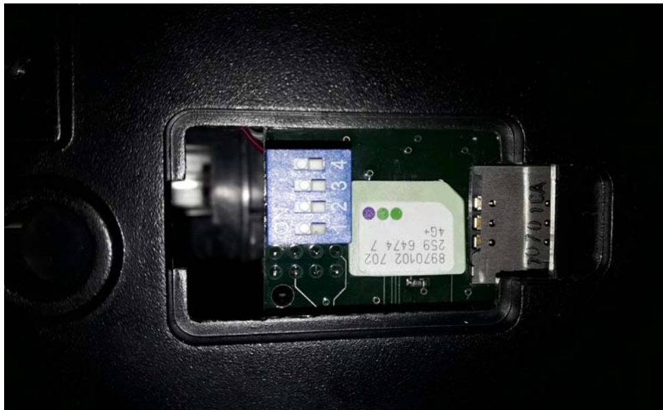
Рисунок 2.3 – Положение SIM-карты для установки
