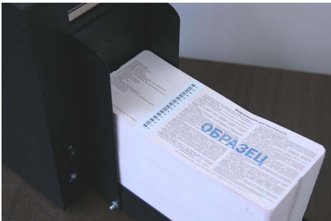
Рисунок 3.1 – Установка пачки БСО в лоток БПУ
