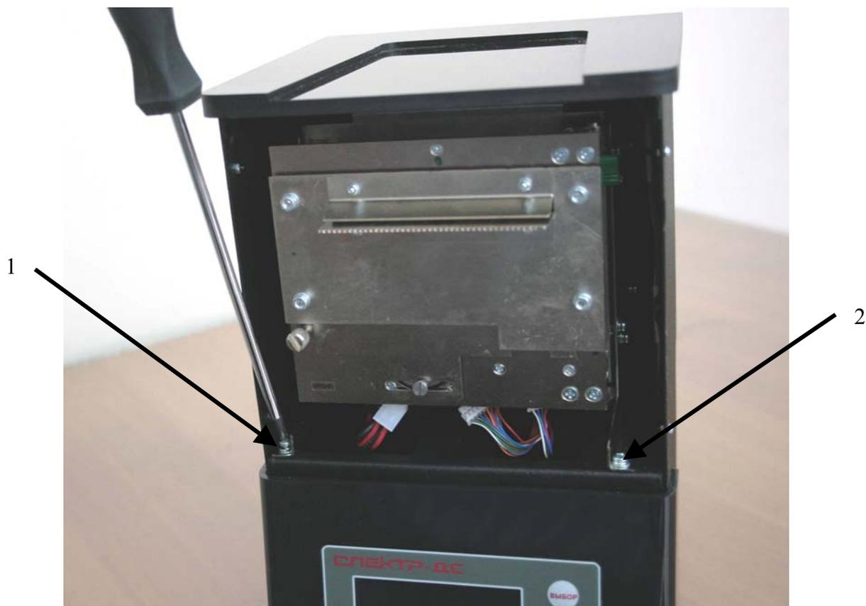
Рисунок 9.14 – Правила съема винтов крепления
