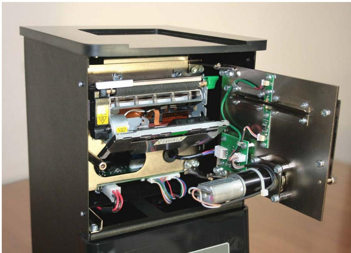
Рисунок 9.7 – Внешний вид БПУ с откинутым прижимным валиком
