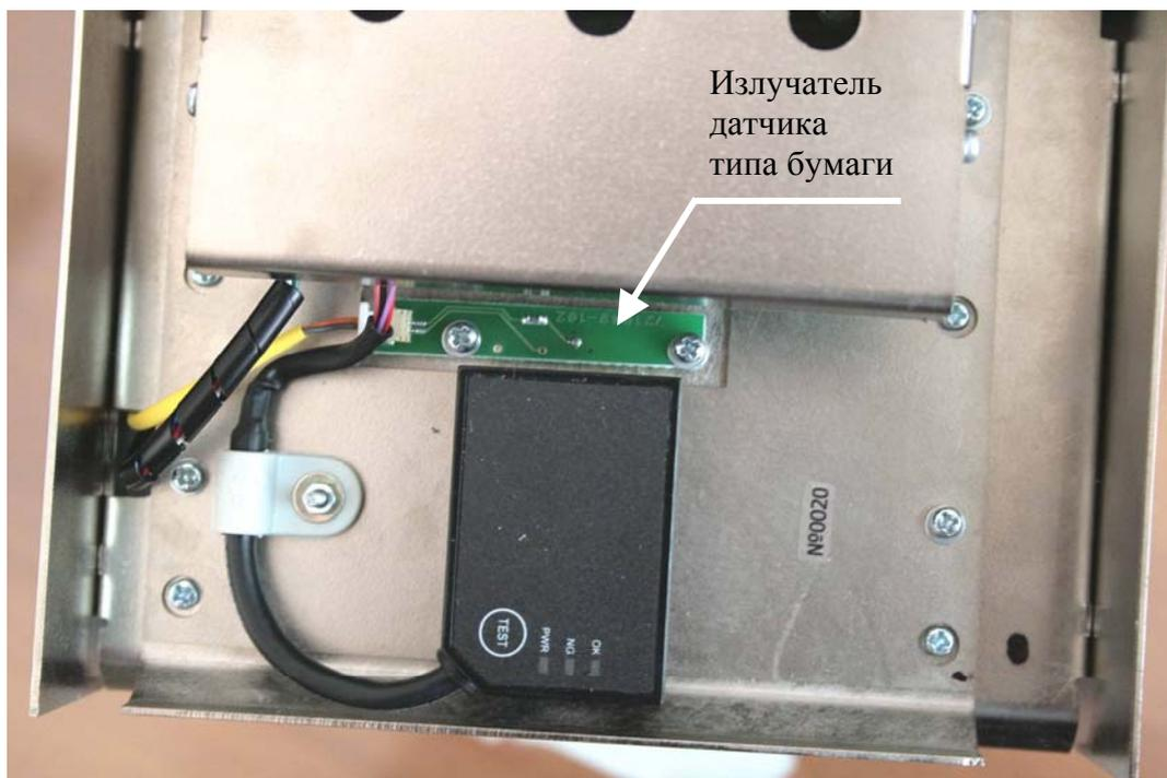
Рисунок 9.17 – Расположение излучателя датчика типа бумаги
