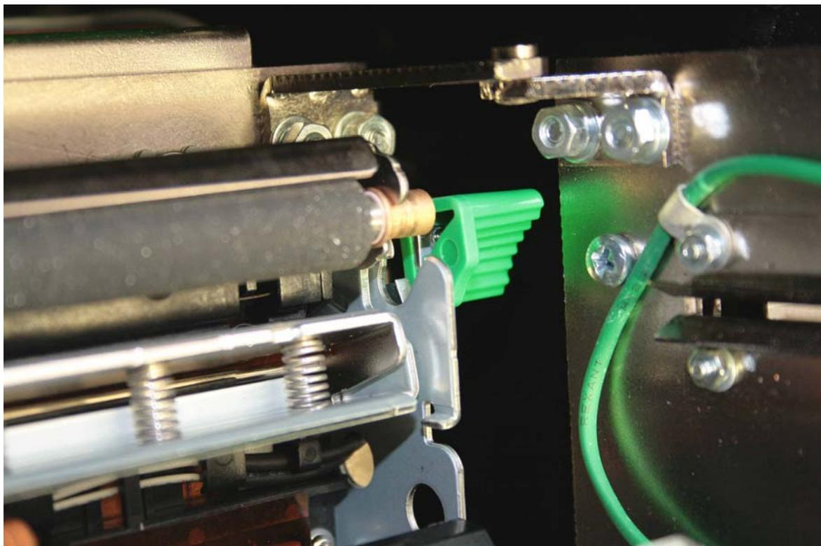
Рисунок 9.9 – Неправильное положение прижимного валика (валик не зашёл в паз)
